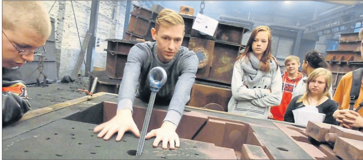
Der angehende Gießereimeister Mayk Ingwersen erklärt einer Schülergruppe den Aufbau einer Sandgussform. Foto: Francis Edler
